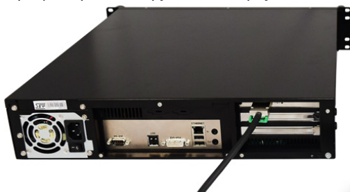
Блок микропроцессора «Эльбрус-4С» в корпусе 2U
