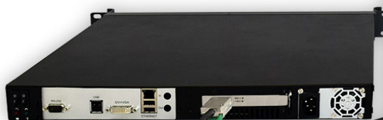
Блок микропроцессора «Эльбрус-4С» в корпусе 1U
